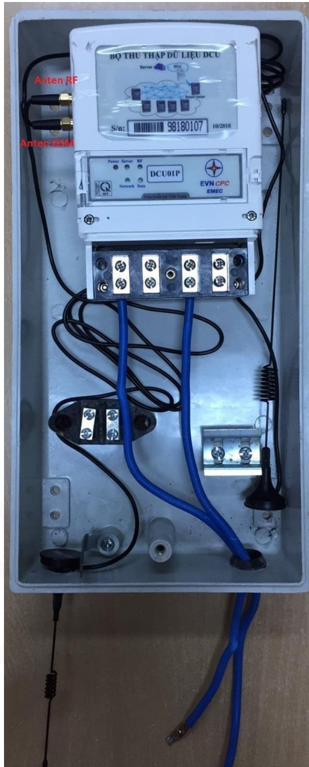
Hình mô tả cách đấu dây DCU kiểu 1 pha
